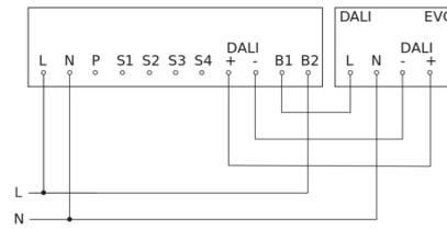
Schéma du circuit principal avec lampe commutée
